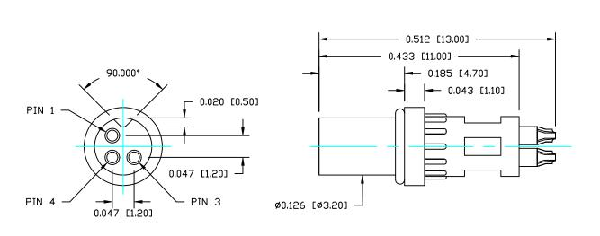
M5 FEMALE - CABLE MOUNT - SOLDER CUP - 3 POSITION
