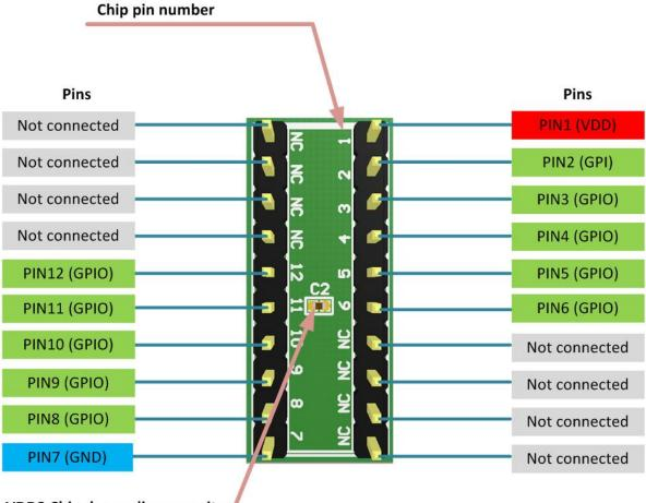
VDD2 Chip decoupling capacitor (optional)
