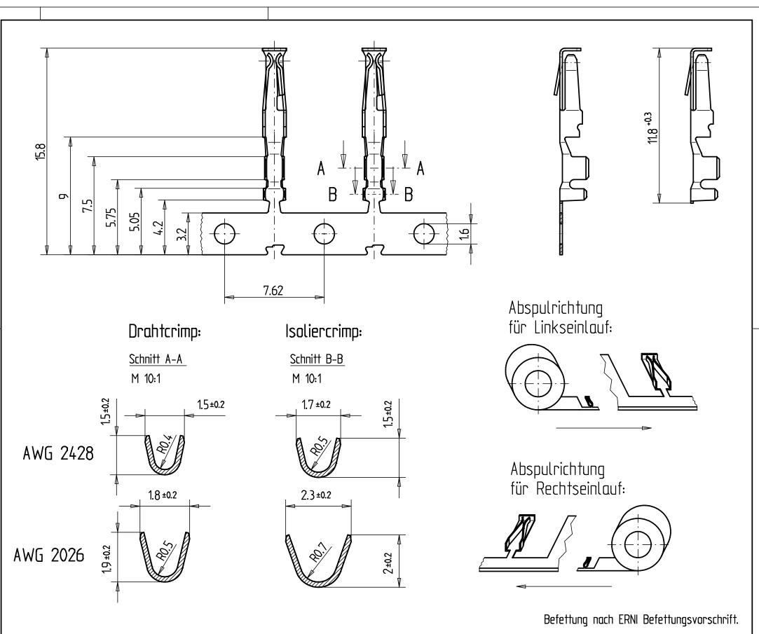
Verwendung für Federleistengehäuse siehe Zeichnung 033803 Zugehöriges Entriegelungswerkzeug siehe Zeichnung 471555 Spulendurchmesser bei 10000 Kontakten: Ø590 500 Kontakten: Ø130
