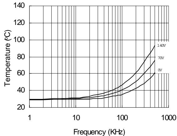
**Figure 26. IR2106 vs. Frequency (IRFBC40),**
