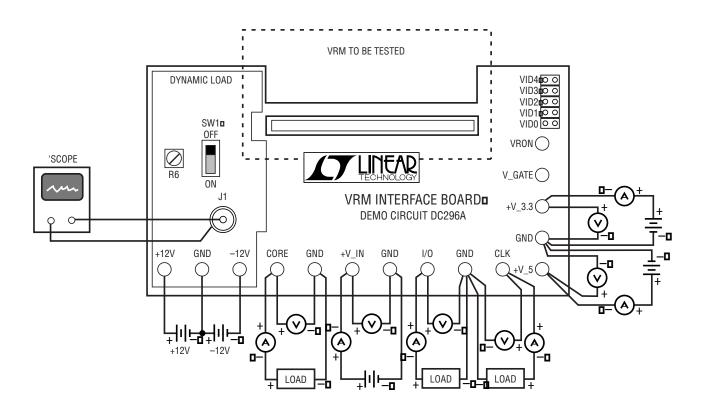
Figure 1. DC296A Hookup Diagram
