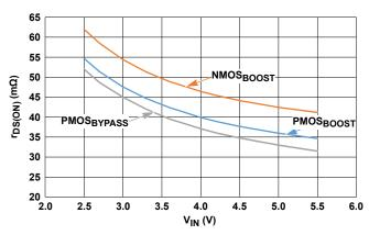
FIGURE 17. MOS r<sub>DS(ON)</sub> vs V<sub>IN</sub>
