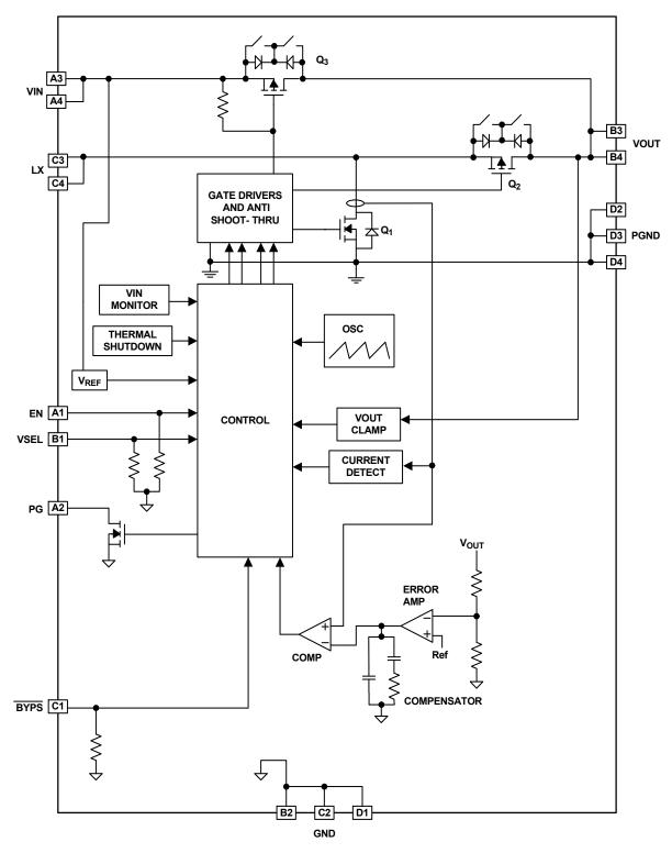
FIGURE 3. BLOCK DIAGRAM
