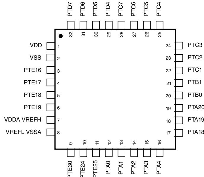
**Figure 20. 32 LQFP Pinout Diagram**
