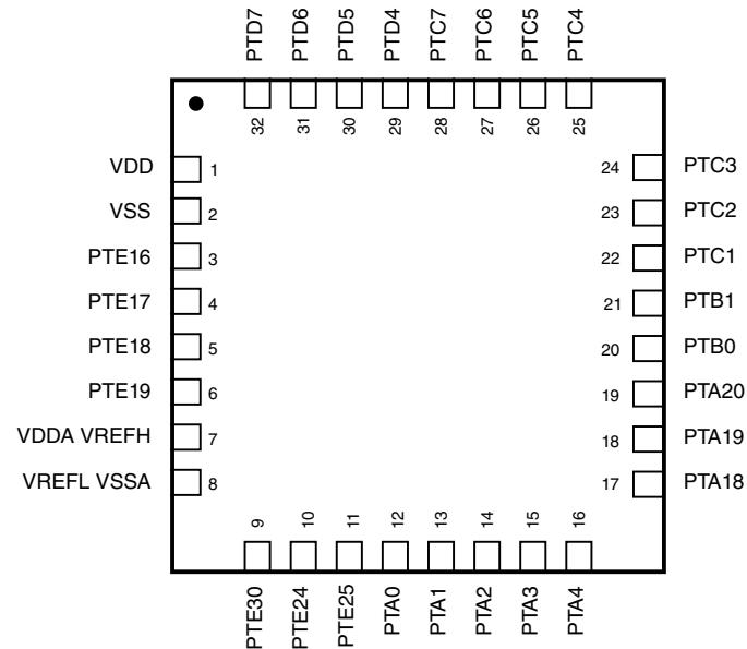
**Figure 19. 32 QFN Pinout Diagram**
