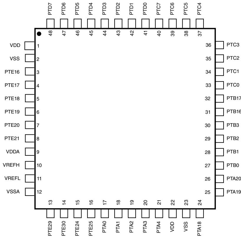
**Figure 18. 48 LQFP Pinout Diagram**
