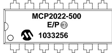
14-Lead SOIC (3.90 mm)
