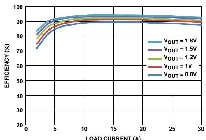
FIGURE 10. EFFICIENCY, V<sub>IN</sub> = 5V, f<sub>SW</sub> = 516kHz
