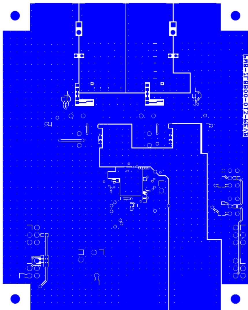
**FIGURE 21. PCB - BOTTOM LAYER (TOP VIEW)**
