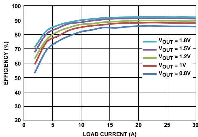
FIGURE 9. EFFICIENCY, V<sub>IN</sub> = 12V, f<sub>SW</sub> = 516kHz
