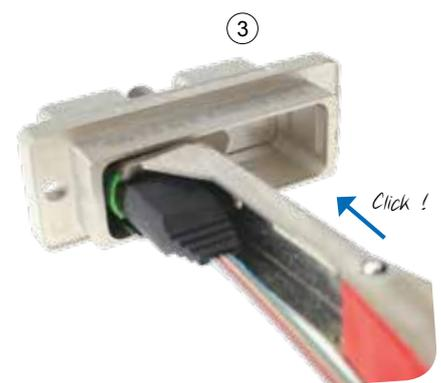
① Présenter le connecteur MPO face au module et le pousser à l'intérieur jusqu'au clic de verrouillage
