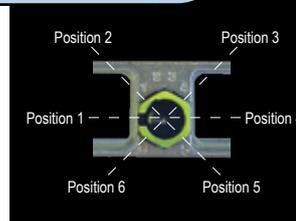
NOTA : En cas de modification de détrompage, vous devez extraire la clé en utilisant la pince 006101 004 00 (page 78) puis remplacer la clé extraite par une clé neuve
