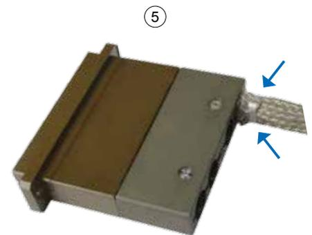
Couple de serrage des vis de capot et de fixation : 0,5 à 0,7 N.m max
