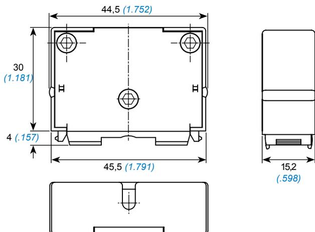
Capot de protection pour composants électroniques câblés ou shunts sur l'arrière des modules.
