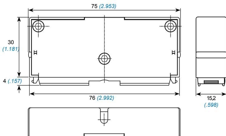
Capot de protection pour composants électroniques câblés ou shunts sur l'arrière des modules.
