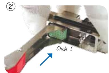
① Présenter le module côté interface à l'arrière du boîtier du connecteur, en face de la cavité présentant le bon détrompage (module détrompé A dans la cavité A, module détrompé B dans la cavité B ... le module standard N pouvant être utilisé dans toutes les cavités)
