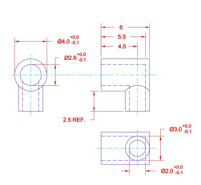
MATERIAL: SILICONE RUBBER UL94V-0
