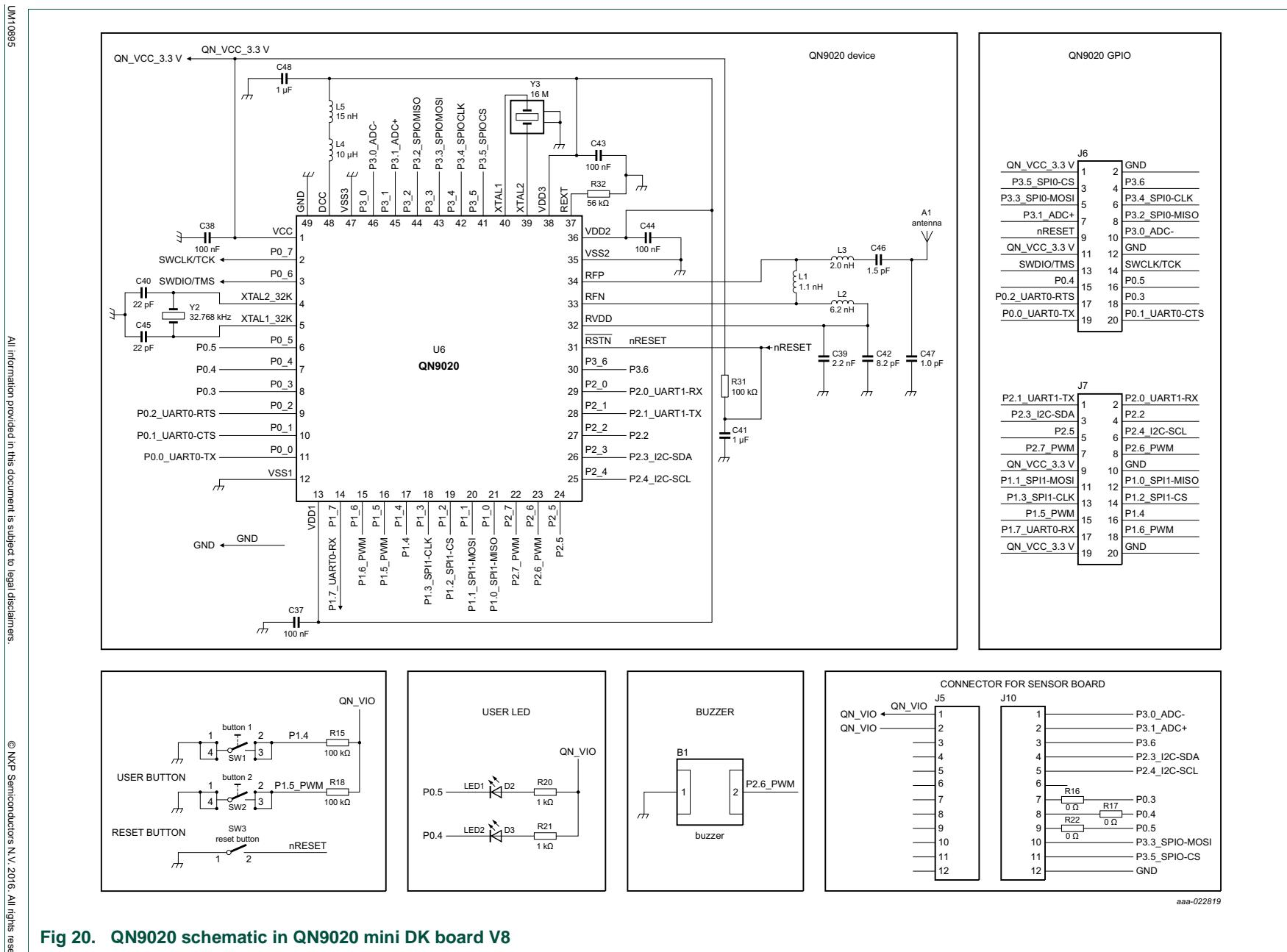
Fig 20. QN9020 schematic in QN9020 mini DK board V8
