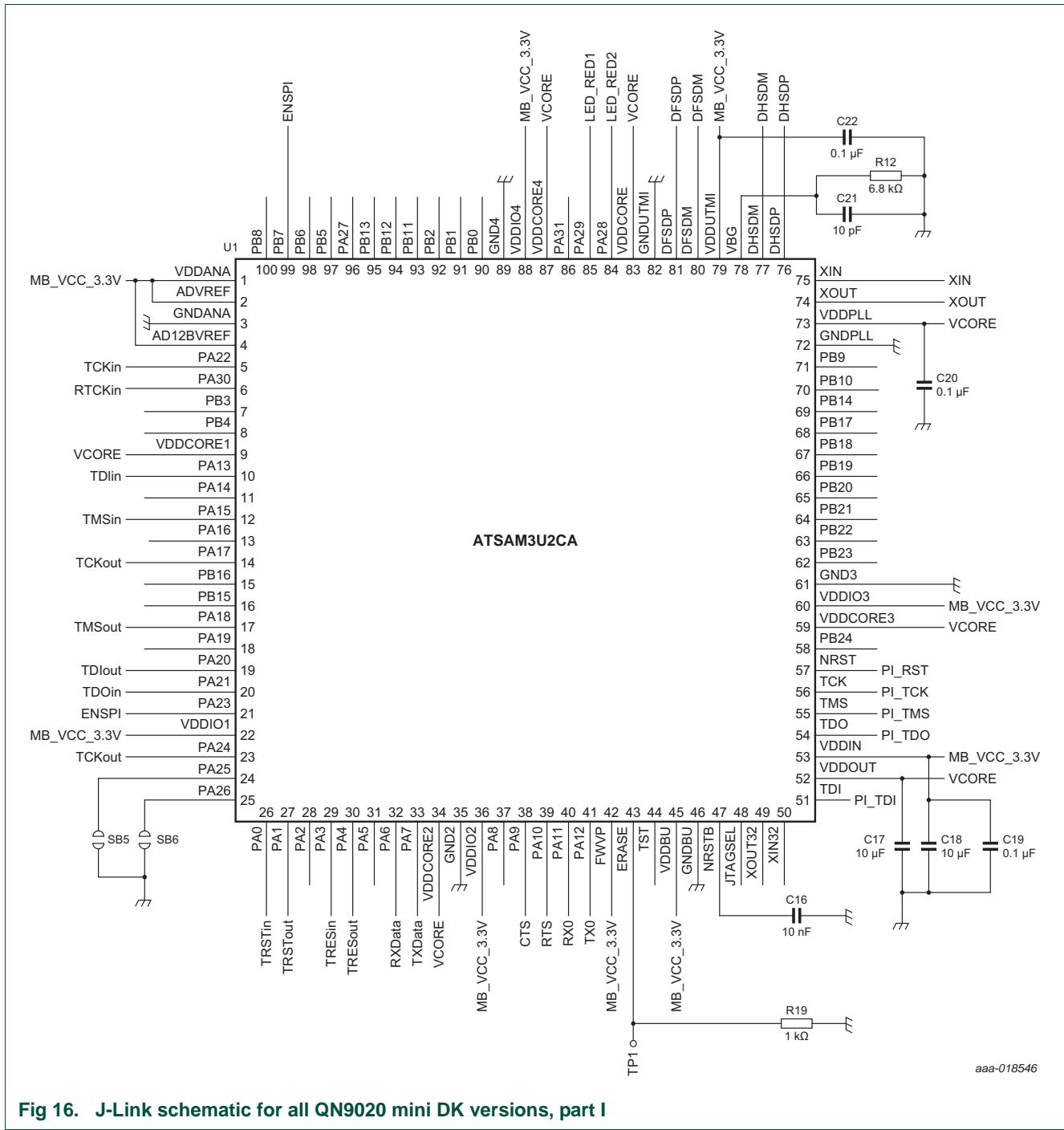
**Fig 16. J-Link schematic for all QN9020 mini DK versions, part I**
