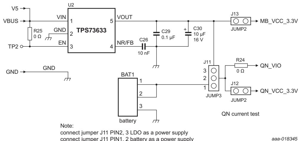
Fig 18. Power schematic for all mini DK versions
