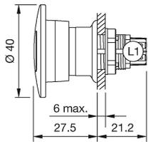
L1 = Löt-/Steckanschluss 2.8 x 0.5 mm
