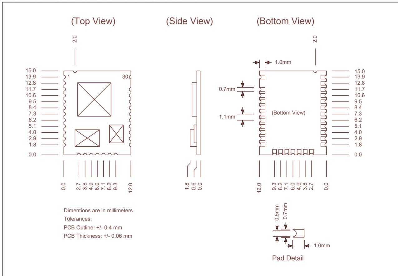
**FIGURE 1-10: BM77SPP03MC2 RECOMMENDED PCB FOOTPRINT**
