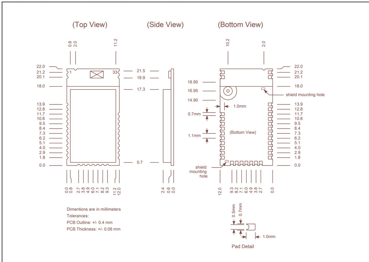
**FIGURE 1-7: BM77SPPS3MC2 RECOMMENDED PCB FOOTPRINT**
