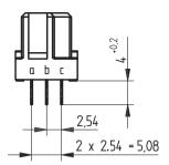
Elastische Einpresszone / compliant pressfit zone Isolierwerkstoff / housing material : PBT GF30
