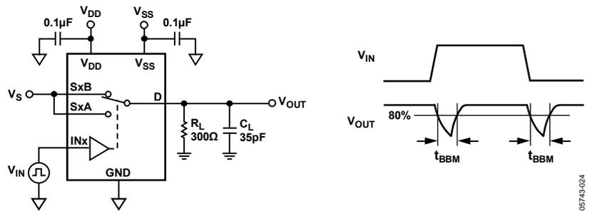
Figure 28. Break-Before-Make Delay
