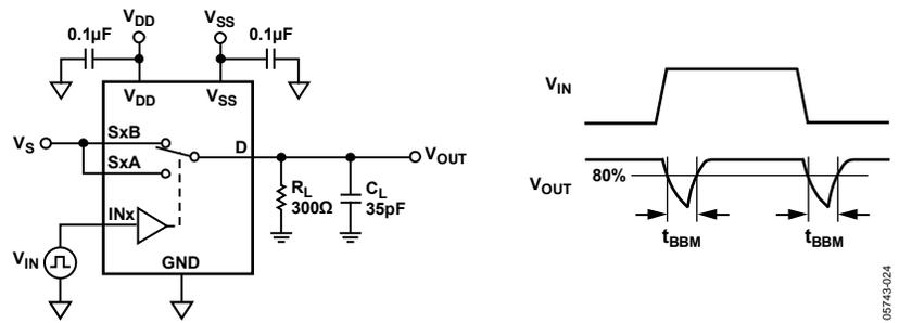
Figure 28. Break-Before-Make Delay
