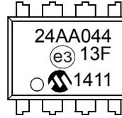
8-Lead SOIC (3.90 mm)
