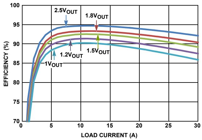
FIGURE 6. EFFICIENCY vs LOAD CURRENT (PARALLEL SINGLE OUTPUT, AS SHOWN IN [Figure 19](#) AT 5V<sub>IN</sub>/500kHz)
