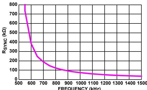
FIGURE 33. R<sub>SYNC</sub> VS SWITCHING FREQUENCY
