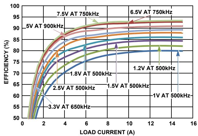
FIGURE 5. EFFICIENCY vs LOAD CURRENT (20V<sub>IN</sub>)
