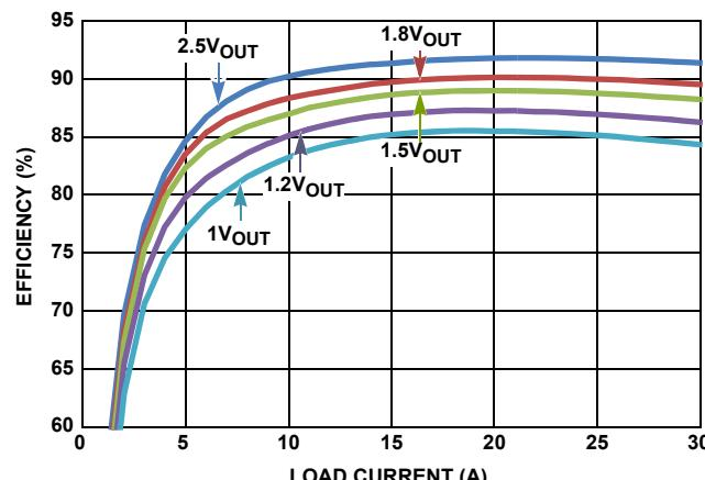
FIGURE 7. EFFICIENCY vs LOAD CURRENT (PARALLEL SINGLE OUTPUT, AS SHOWN IN [Figure 19](#) AT 12V<sub>IN</sub>/500kHz)
