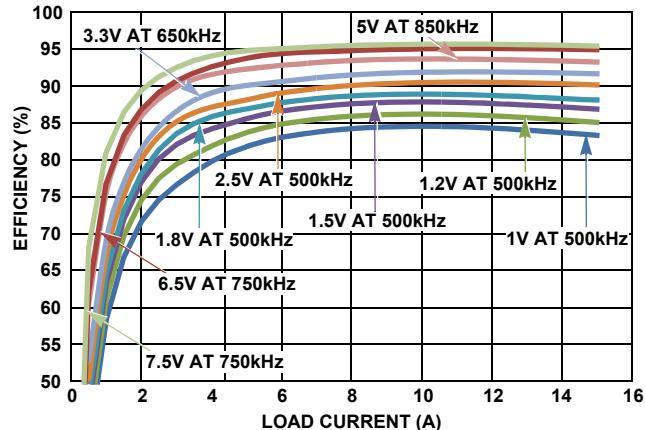
FIGURE 4. EFFICIENCY vs LOAD CURRENT (12V<sub>IN</sub>)
