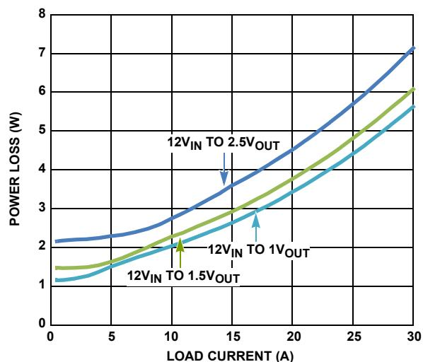
FIGURE 36. POWER LOSS CURVES OF 12V<sub>IN</sub>
