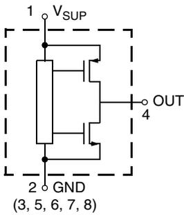
**Fig. 4-6:** Pin configuration (SOIC8)
