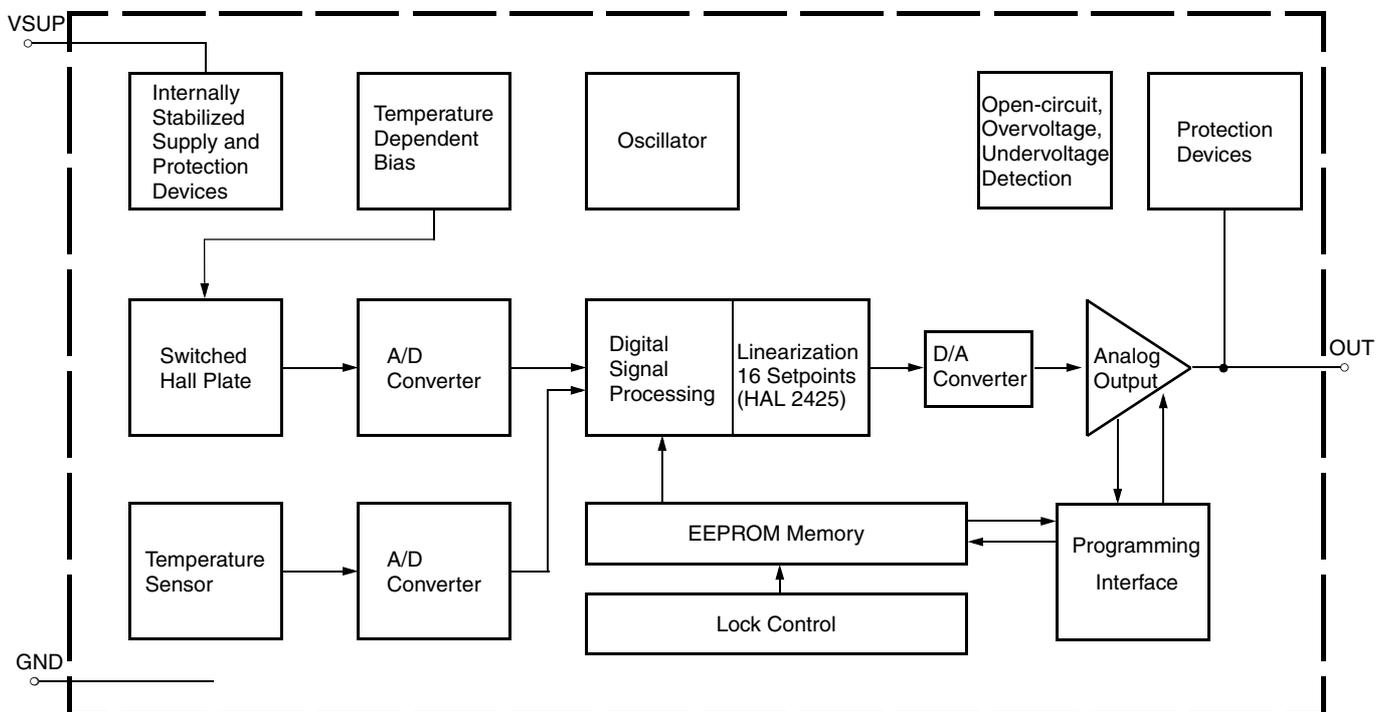
**Fig. 3-1:** HAL 242x block diagram
