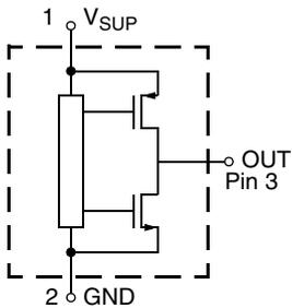
**Fig. 4-7:** Pin configuration (TO92UT)
