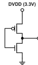
Figure 29. CMOS Output
