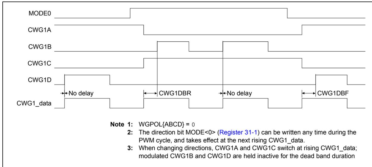
**FIGURE 31-9: CWG HALF-BRIDGE MODE OPERATION**
