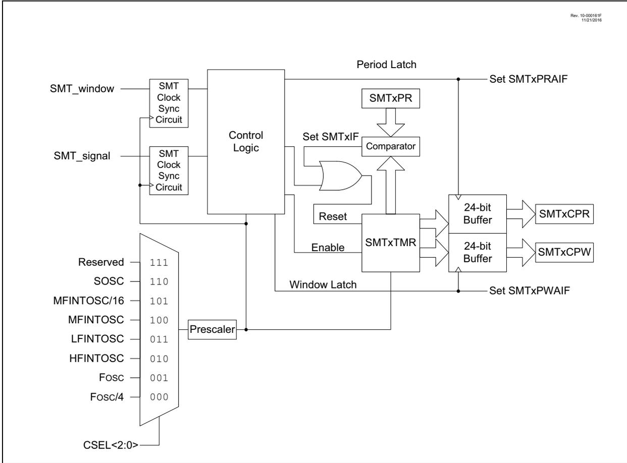
**FIGURE 28-2: SMTx SIGNAL AND WINDOW BLOCK DIAGRAM**
