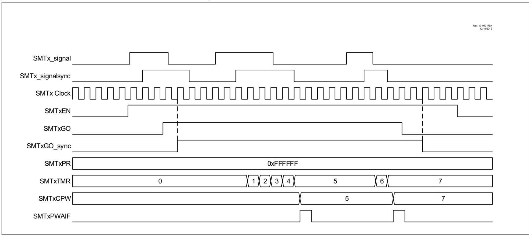
**FIGURE 28-5: GATED TIMER MODE SINGLE ACQUISITION TIMING DIAGRAM**
