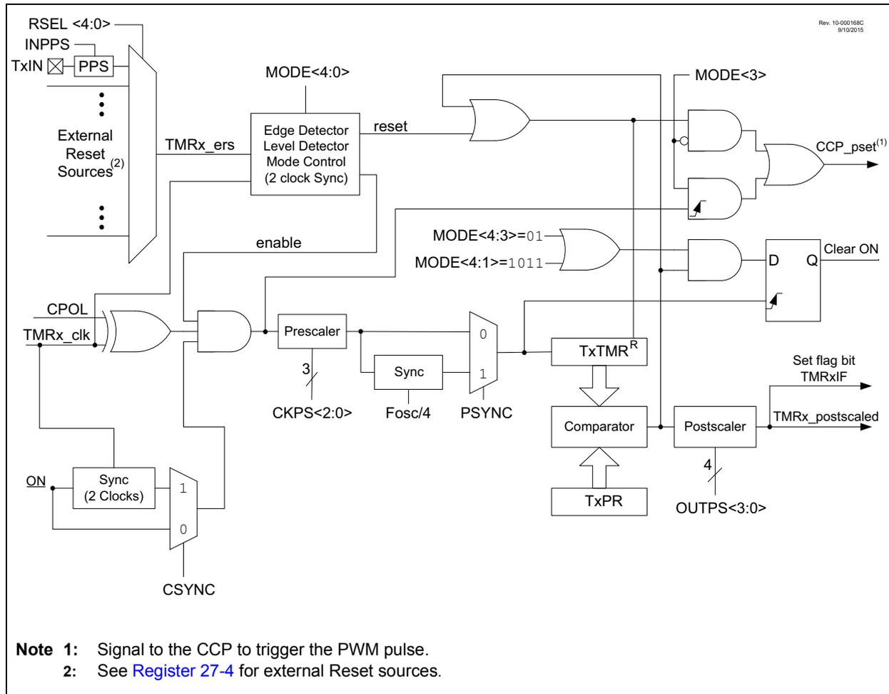
**FIGURE 27-2: TIMER2/4 CLOCK SOURCE BLOCK DIAGRAM**
