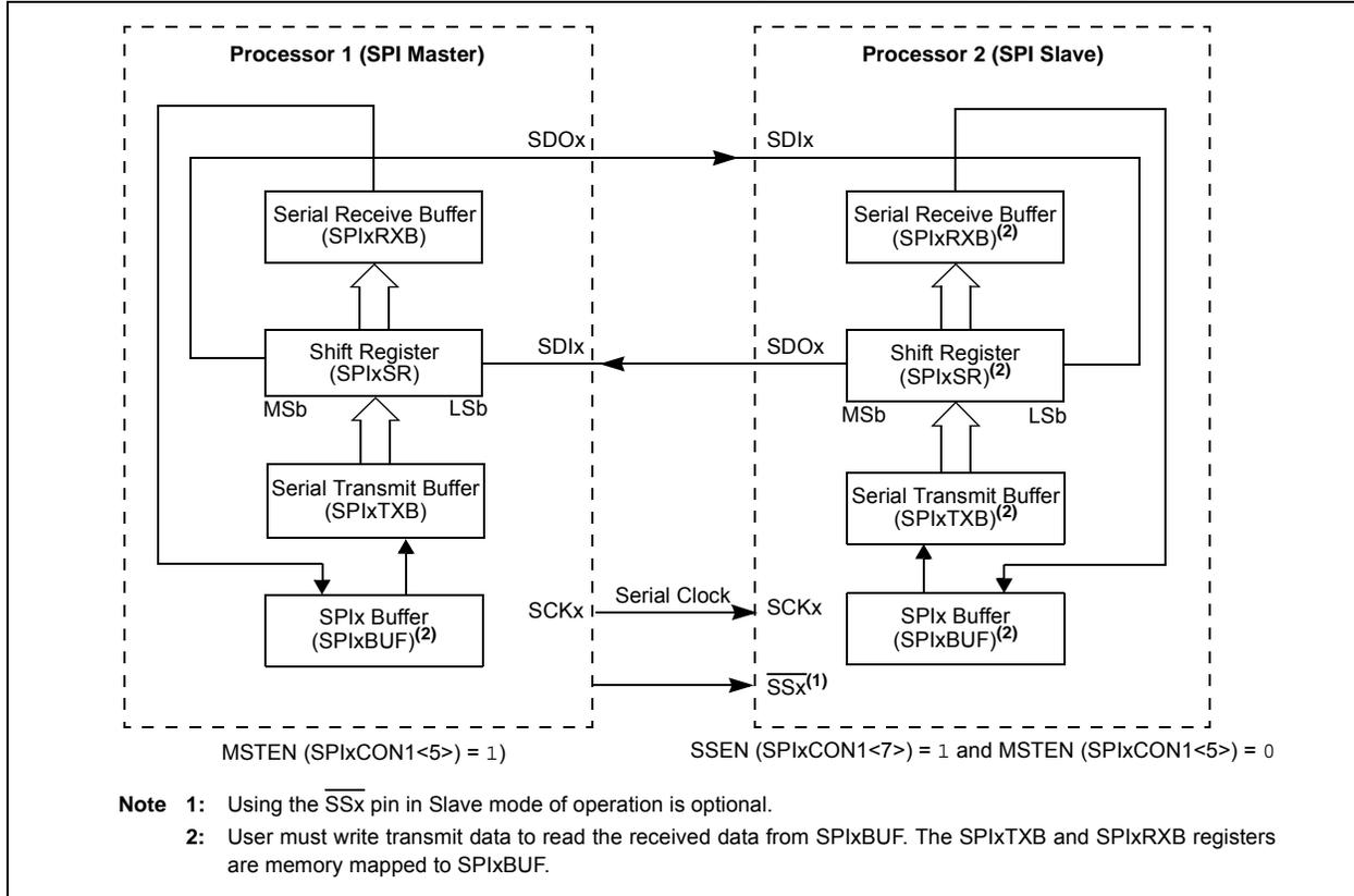
**FIGURE 16-4: SPI MASTER/SLAVE CONNECTION (ENHANCED BUFFER MODES)**
