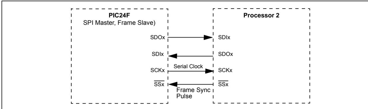
**FIGURE 16-7: SPI SLAVE, FRAME MASTER CONNECTION DIAGRAM**
